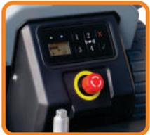
Display traz informação de bateria, horímetro e códigos de erro graças a tecnologia do controlador CURTIS integrado ao sistema CAN-bus fazendo o diagnóstico e solução de problemas ainda mais fácil. Acesso através de PIN code ou RFID.
