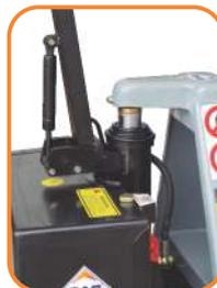
Bomba hidráulica e bateria, protegidas por uma caixa de ferro e plástico para evitar a exposição a poeira e possível choques durante o uso.
