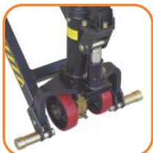
Rolete de apoio excêntrico funciona para fixação e frenagem da máquina após 200 mm de altura.
