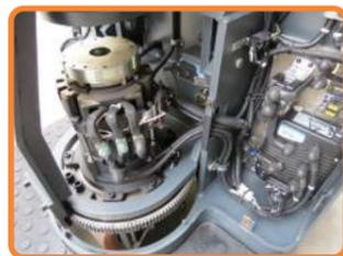
Motor de tração AC de 3.8kw importado da Alemanha, aliado aos melhores componentes do mercado mundial garantem o incrível desempenho deste equipamento. Velocidade máxima de 14 Km/h.
