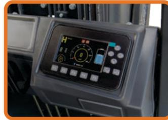
Painel Curtis reúne diversas informações para o operador, trabalha em conjunto com módulos Curtis e motores AC que combinam baixo consumo de energia, alto desempenho e manutenção extremamente reduzida.
