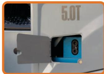
Abertura especial para o carregador com conector Rema para maior segurança e comodidade nas recargas normais e de ocasião.
