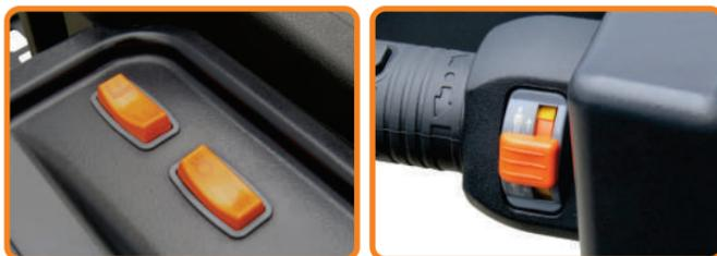
Manoplas de controle - Controle de deslocamento e elevação da plataforma podem ser feitos simultaneamente, sensores exigem que o operador esteja com as duas mãos dentro da plataforma para maior segurança.
