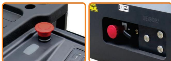
Dispositivos de segurança - Limitação de velocidade em alturas, botão de emergência, sensores de presença e acionamento manual de descida são apenas alguns dos itens que fazem do SPTE30 uma referência em segurança.
